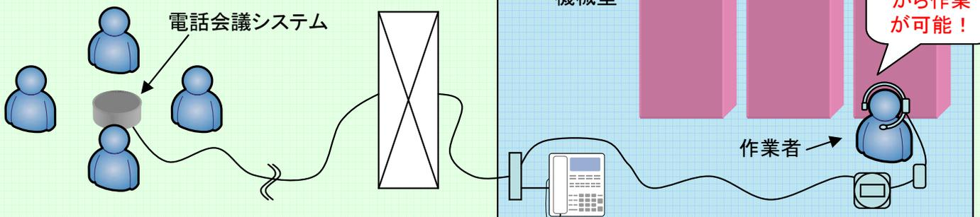
電話機に接続されるモジュラーケーブルを分配し、電話機と専用レシーバを接続する。電話機から作業場所が離れてこることもあるため延長式モジュラーケーブルを用意。作業員は専用レシーバ(ヘッドセット)により両手が自由となるため、指示を確認しながら作業を行うことが可能となる。
