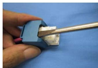
⑪コネクタクリップの取り外しは、小さなドライバーを使って簡単にできます。
