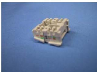
③ケーブルマネージャーの側面にあるカラーコードを確認します。568A/568Bのどちらにも対応しています。
