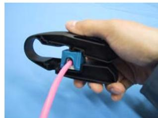
⑨コネクタクリップをケーブルマネージャーと本体の上にかぶせ、カッチッと音がするまで上から下へスライドさせながら押し込みます。
