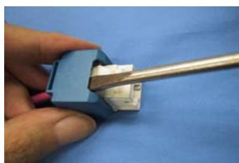
⑪コネクタクリップの取り外しは、小さなドライバーを使って簡単にできます。
