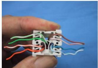
⑥各ペアの擦りをできるだけ最後まで保ちながら、ケーブルをケーブルガイドの上から押し込みます。(側面のカラーコードと一致しているか確認してください。)
