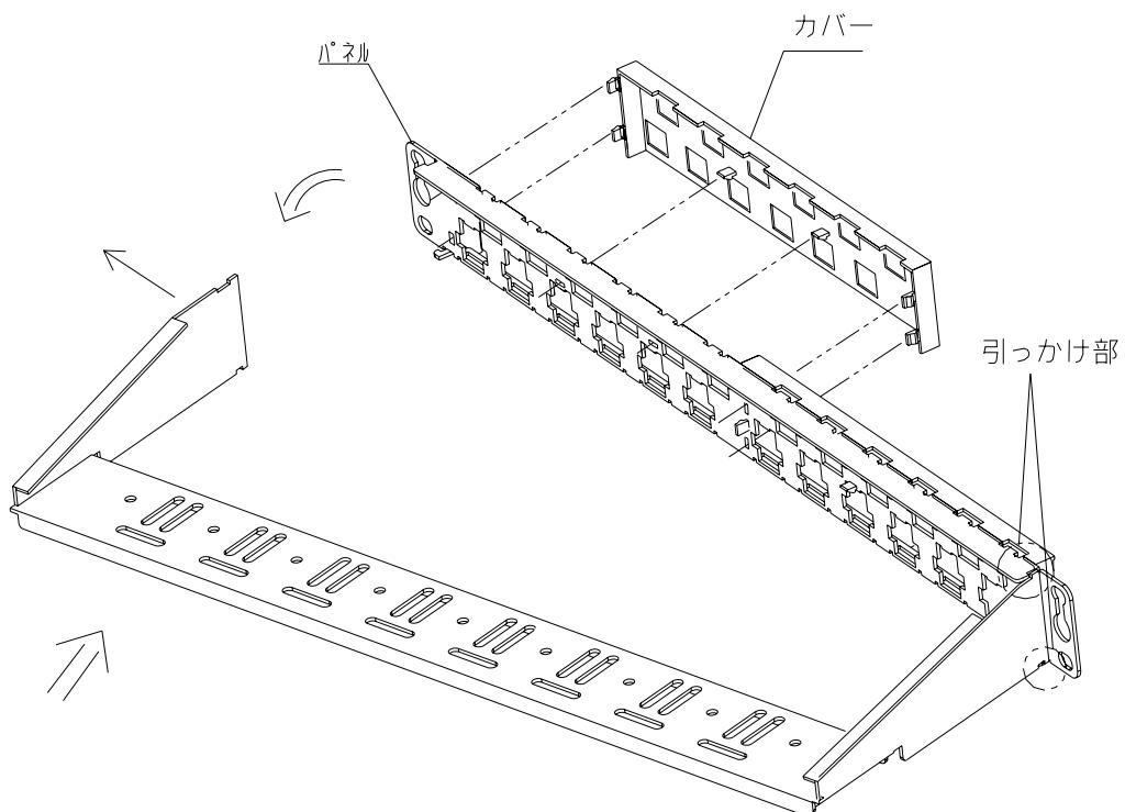
②図のようにはじめに片側のパネルとブラケットの引っかけ部を差し込むように引っかけます。
