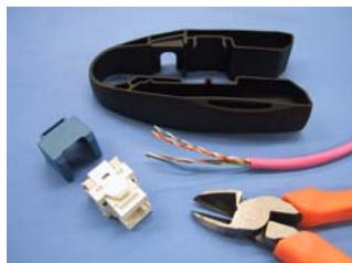
①ジャック本体(ケーブルマネージャーを含む)とコネクタクリップ(同梱・ブルー)およびニッパー、ターミネーションツールを用意します。
