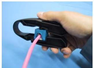
⑨コネクタクリップをケーブルマネージャーと本体の上にかぶせ、カチッと音がするまで上から下へスライドさせながら押し込みます。
