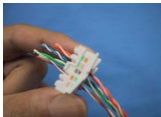
④側面のカラーコードにしたがってケーブルマネージャーの導入口に各ペアごとにケーブルを差し込みます。
